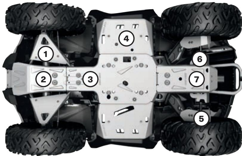
Für ultimative Beständigkeit und Robustheit ist unser gesamter Aluminium-Unterbodenschutz aus Aluminium 5052 H32 mit einer Dicke von 4,5 mm gefertigt.
