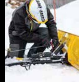
Das Windeseil mit einem Führungshaken/ einer Führungswalze am Schild anbringen.
