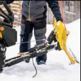
Retira el cable del cabrestante de la guía. Estás listo para empujar la pala.
