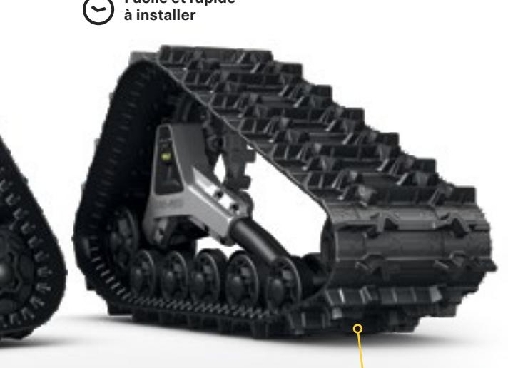
Les roues double roulement à surmoulage en caoutchouc et l'espacement décalé entre les roues réduisent la friction et les vibrations, tout en assurant la fiabilité
