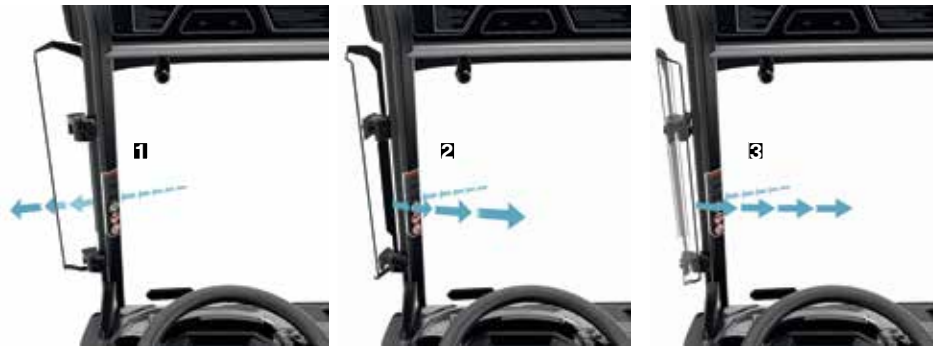
LE PRESE D'ARIA INFERIORI CONSENTONO L'ANTIAPPANNAMENTO DEL PARABREZZA
