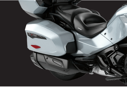
SUSPENSIÓN DE NIVELACIÓN AUTOMÁTICA Amortiguación trasera controlada por aire con ajuste automático al peso del pasajero...
