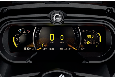
INDICADOR DIGITAL Amplia pantalla LCD panorámica de 7,8 pulgadas (19,8 cm) a color, con BRP Connect™ y panel de control de audio...
