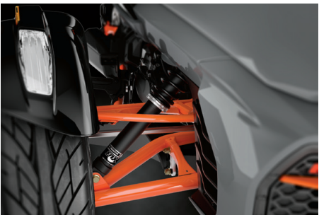
AMORTISSEURS FOX† Les amortisseurs avant à gaz calibrés pour le sport apportent réactivité, sensations sportives et performances exceptionnelles sur les routes les plus exigeantes.
