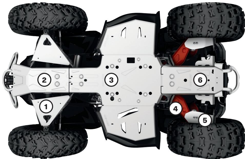
Para ofrecer durabilidad y resistencia óptimas, todos nuestros protectores de chasis de aluminio están fabricados de aluminio 5052-H32 de alta resistencia y 4,5 mm de espesor.
