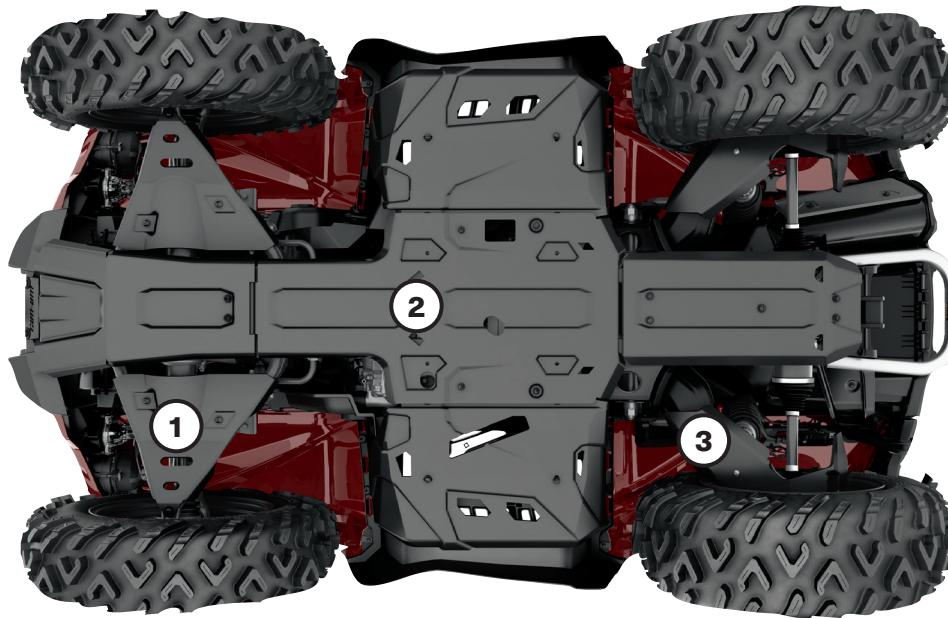
Nuestros protectores de plástico se deslizan suave y silenciosamente por los obstáculos para ofrecer excelente protección en terrenos abruptos. Fabricados de polietileno de ultra alto peso molecular (HMWPE) termoformado resistente a la abrasión de 6 mm de espesor.
