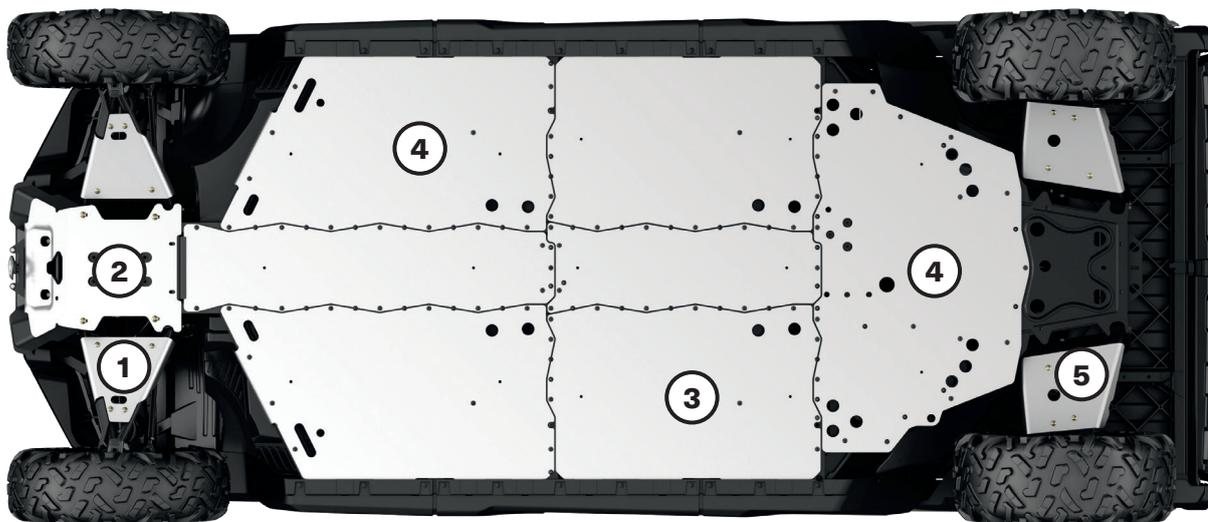
Para ofrecer durabilidad y resistencia óptimas, todos nuestros protectores de chasis de aluminio están fabricados de aluminio 5052-H32 de alta resistencia y 4,5 mm de espesor.
