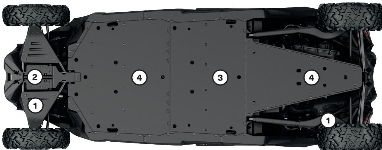
Nuestros protectores de plástico se deslizan suave y silenciosamente por los obstáculos para ofrecer excelente protección en terrenos abruptos. Fabricados en polietileno de ultra alto peso molecular (HMWPE) termoformado resistente a la abrasión de 10 mm de espesor.
