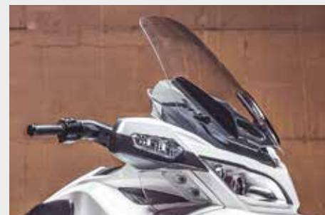
**PARA-BRISA ELÉTRICO AJUSTÁVEL:** Amplia proteção contra o vento ajustável ao apertar de um botão.
